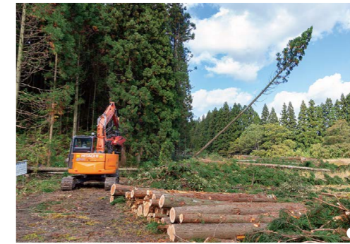
①ベテランチームがチェーンソーで伐倒した木をプロセッサで集積していく。近年、利用間伐が増えたので高性能林業機械をそろえた。ほかにグラブ、バックホウ、フォワーダを使用 ②左から総務課長の渡辺友樹さん、森林技術員の齋藤拓真さん、野村直哉さん。渡辺さんは森林技術員の経験があり、森林施業プランナーの資格も持つ
